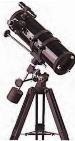
Αυτό το Νευτώνειο τηλεσκόπιο έχει μια μικρή εστιακή απόσταση 1000 χιλ. και άνοιγμα 114 χιλ. άρα έχει εστιακό λόγο 1000/114=8,7
